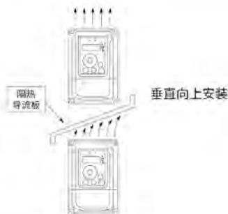
图 3-1 变频器安装空间要求
