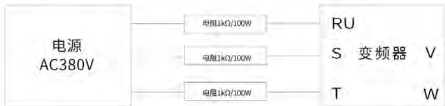
图 8.1 380V 驱动装置充电电路示例
